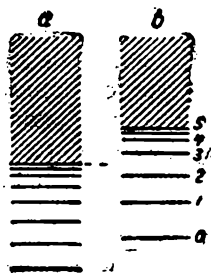
Фиг. 13. Колебательные уровни двух электронных состояний, a и b ; двухатомной молекулы для пояснения преддиссоциации. Заштрихованные поверхности изображают диссоциационные континуумы.
